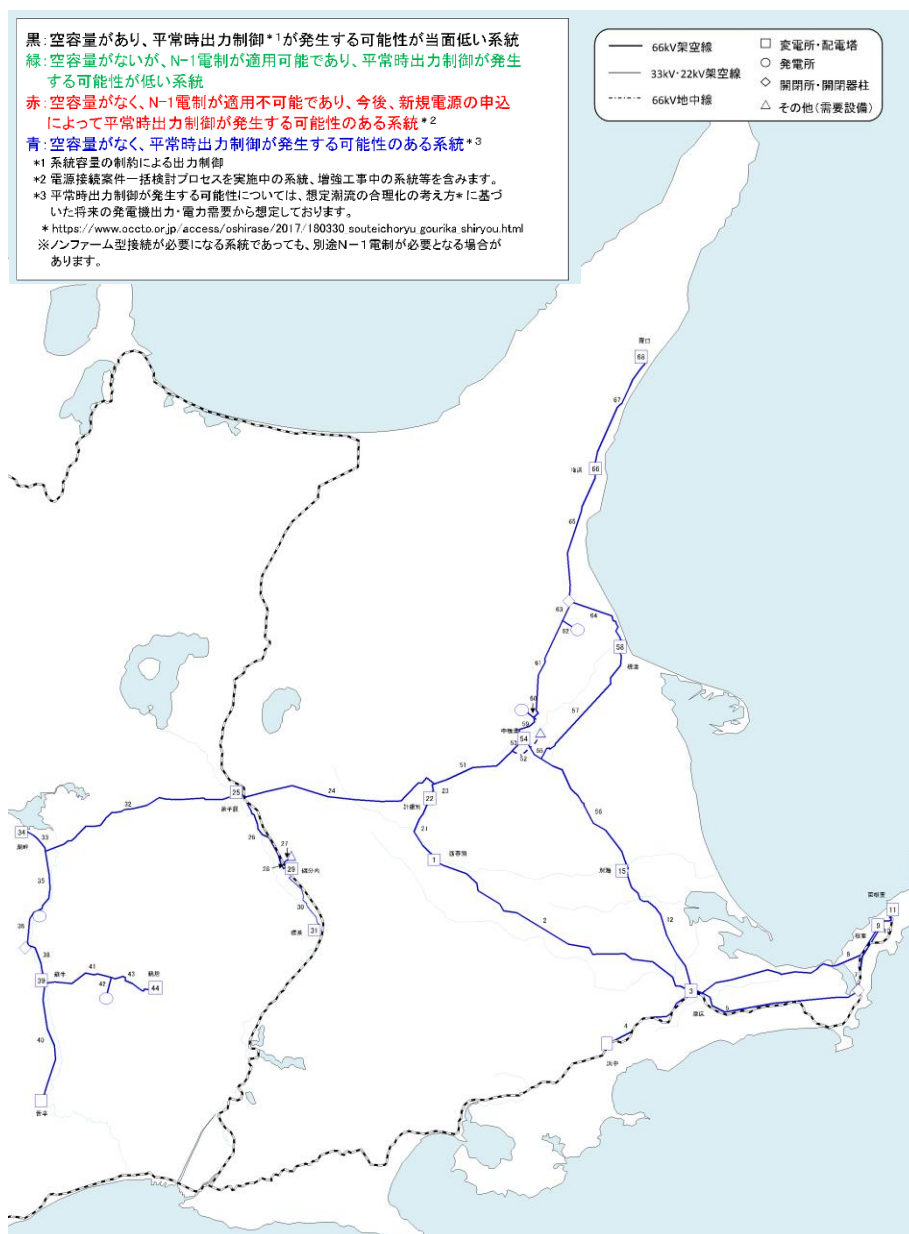
図 4.12 道東エリアにおける系統連系の空き容量 2022 年 12 月時点)
